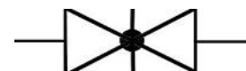
Вариант 4. Знак "Задвижка клиновья или шиберная" Шаровой кран так обозначать неверно, но обозначают так часто.
