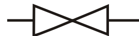
Вариант 2. Знак "Вентиль проходной". Шаровой кран так обозначать неверно, но обозначают так часто.
