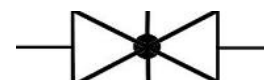
Вариант 4. Знак "Задвижка клиновая или шиберная" Шаровой кран так обозначать неверно, но обозначают так часто.
