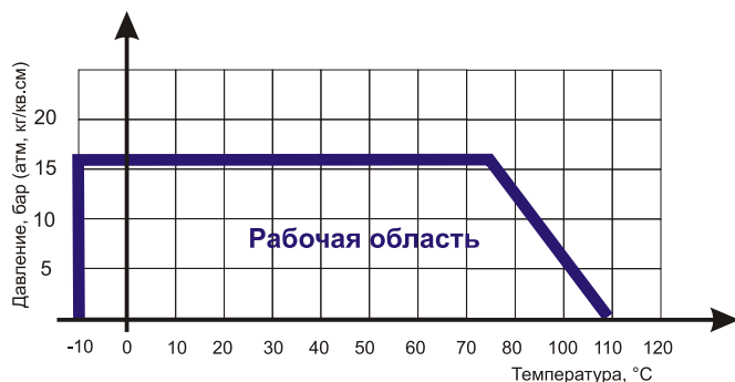
Диаграмма Давление / Температура для клапана обратного ABRA-D-122
