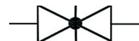
Вариант 4. Знак "Задвижка клиновидная или шиберная". Шаровой кран так обозначать неверно, но обозначают так часто.
