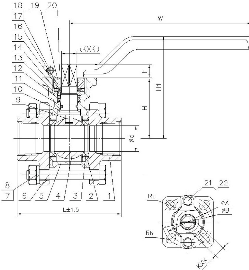
'словное графическое изображение шарового крана из нержавеющей стали на чертежах и схемах :
