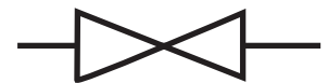
Вариант 3. Знак "Вентиль проходной". Шаровой кран так обозначать неверно, но обозначают так часто.
