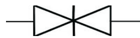
Вариант 4 Знак "Задвижка клиновая или шибберная" Шаровой кран так обозначать неверно, но обозначают так часто.
