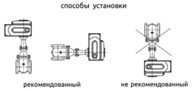
Рис.4. Рекомендуемые способы установки.
