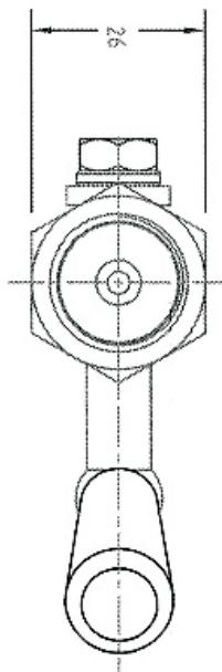
**Условное графическое изображение крана под манометр (клапана к манометру) на чертежах и схемах:**
