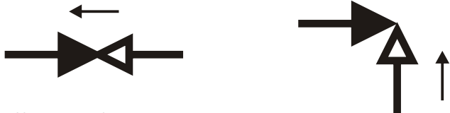
Условное графическое изображение обратного клапана на чертежах и схемах
