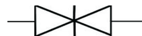
Вариант 3. Знак "Задвижка клиновья или шибберная" Шаровой кран так обозначать неверно, но обозначают так часто.
