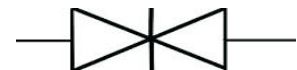
Вариант 3. Знак "Задвижка клиновья или шиберная" Шаровой кран так обозначать неверно, но обозначают так часто.
