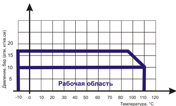
Диаграмма Давление / Температура для затвора поворотного дискового ABRA-BUV-FL226Dxxx DN 50-1000, PN 10 и PN 16
