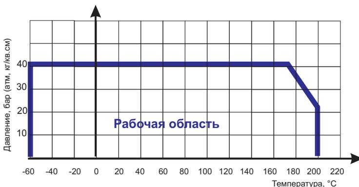
Диаграмма определяет рабочую область для фильтра сетчатого резьбового из нержавеющей стали в координатах Давление (в барах приборного) / Температура (°C).
