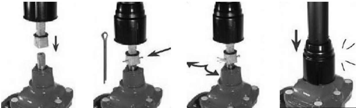
Рис. 4 Порядок установки телескопического штока на задвижку.
