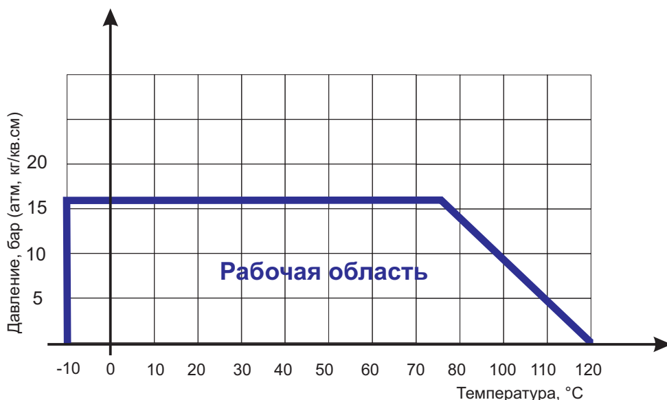
Диаграмма Давление / Температура для задвижки клиновой ABRA-A40-16G с обрезиненным клином и неподвижным штоком DN 40-600 PN 16:
