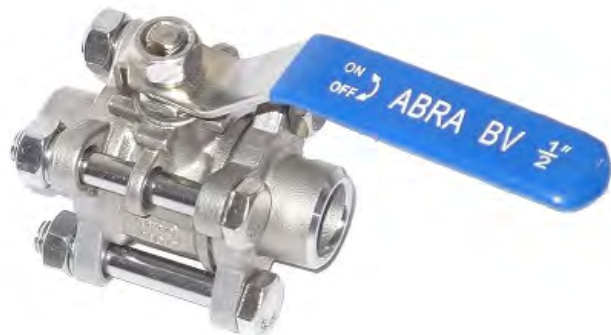
Внешний вид шаровых кранов нержавеющих из стали AISI316 (CF8M) DN 8-100 PN 40 сварка/сварка стандартные патрубки. Тип ABRA-BV61A
